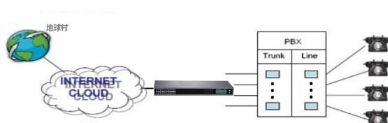
将GXW4200配置在没有PBX的VoIP网络
