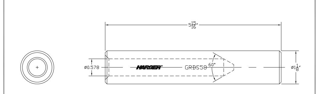
STEEL DRIVE SLEEVE FOR Ø5/8 COPPER CLAD
